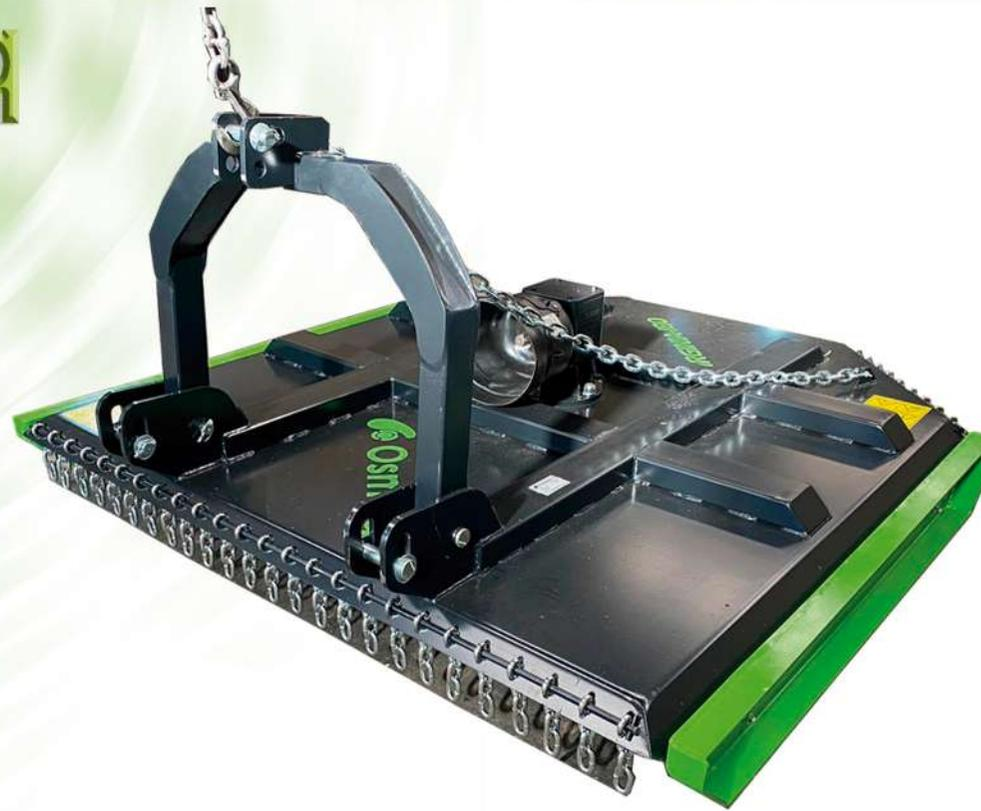
Se trata de una desbrozadora de plato rotor semi-forestal con una transmisión mecánica mediante toma de fuerza y transmisión directa la caja de engranajes.
